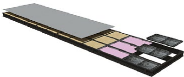
Figura 5. Bandejas de piso con aislación térmica
