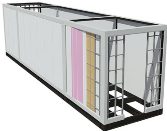
Figura 10. Shelter especial con paredes revestidas
