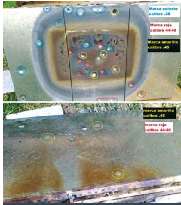
Figura 2 (video). El shelter es sometido a impactos de extrema dureza y los resiste exitosamente
